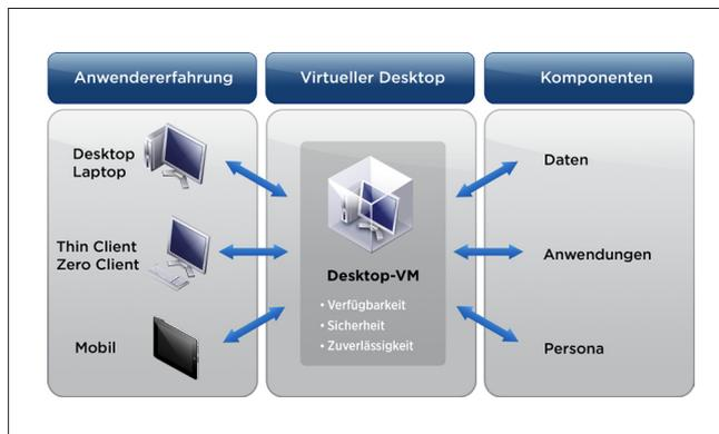
VMware View kapselt Betriebssystem, Profile, Anwendungen und Anwenderdaten in isolierte Schichten, um ein besseres Desktop-Management zu ermöglichen und je nach Bedarf dynamische Desktops zusammenzustellen. Auf diese Weise erhalten Anwender eine personalisierte Ansicht ihres jeweiligen Desktops.
