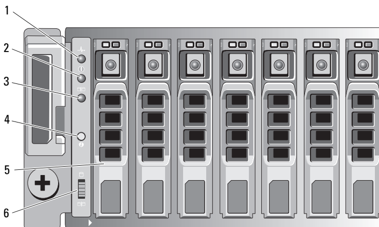
Abbildung 2-2. Funktionen und Anzeigen auf der Vorderseite – Dell PowerVault MD3620f
