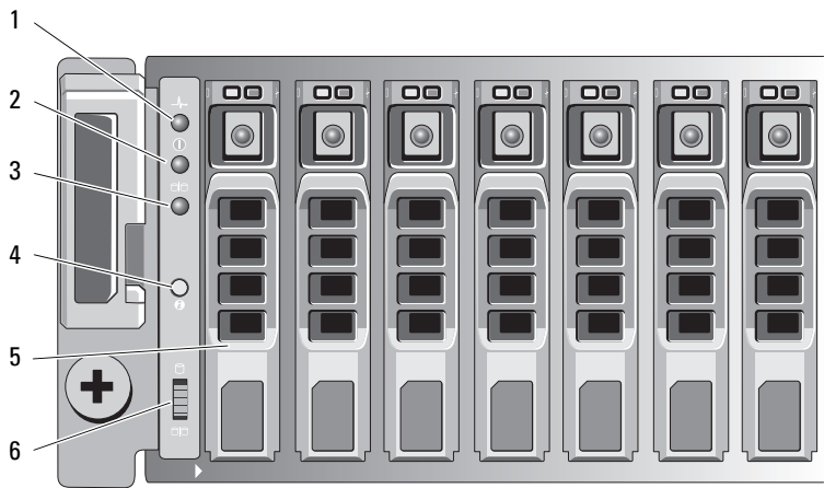
Abbildung 2-2. Funktionen und Anzeigen auf der Vorderseite – Dell PowerVault MD3200i
